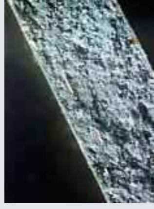
Une seule couche (amiante intégré)
